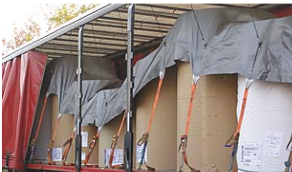
Figura 31: Sujeción con cubierta
