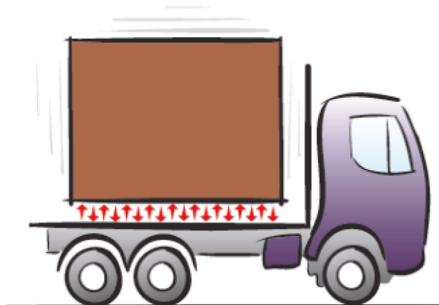
Figura 3: Vibración vertical durante la conducción
