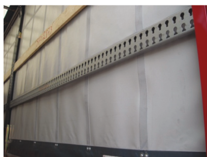
Figura 27: Listones de aluminio con orificios para barras de bloqueo
