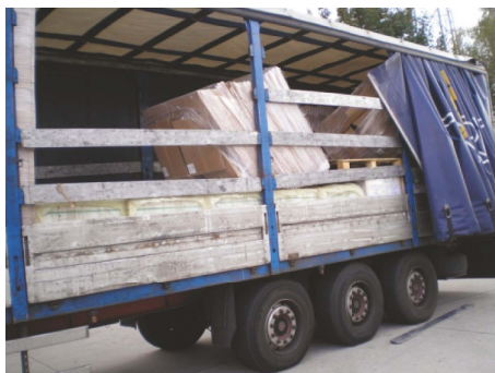
Figura 19: Sujeción de carga insuficiente solo con película envolvente elástica
