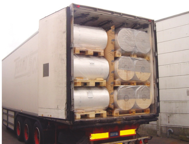
Figura 28 Relleno entre las filas de carga
