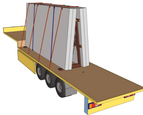
Figura 48: Sujeción con una combinación de bloqueo, bastidor en A, amarre circular y amarre superior
