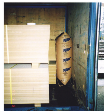
Figura 29: Colchón de aire para bloqueo lateral
