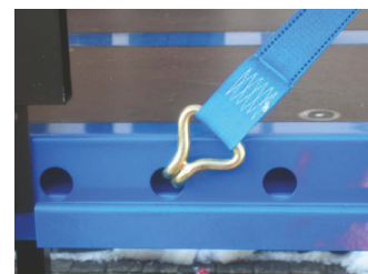
Figura 13: Orificio de anclaje en el perfil lateral
