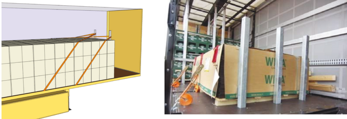
Figura 7: Puntales usados como bloqueos en la dirección de avance
